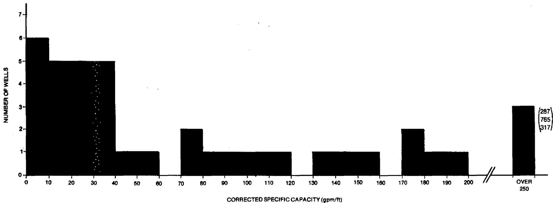
Figure 70 FREQUENCY DISTRIBUTION OF THE CORRECTED SPECIFIC CAPACITIES OF 39 WELLS IN THE FLORIDAN AQUIFER SYSTEM
